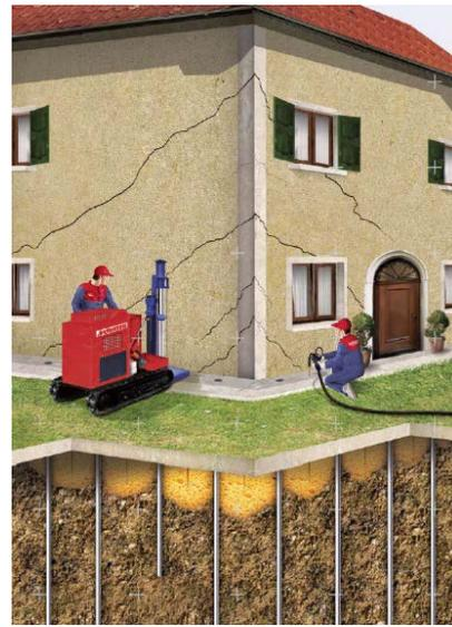
Figura 6-19. Recalce de zapatas corridas mediante: a) inyecciones de resinas expansivas y b) minipilotes metálicos de pequeño diámetro (aprox. 50 mm) combinados con inyecciones de resinas expansivas.
