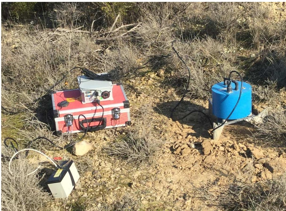
Ejemplo de uno de los tipos de instrumentación instalada durante la intervención postsísmica.
