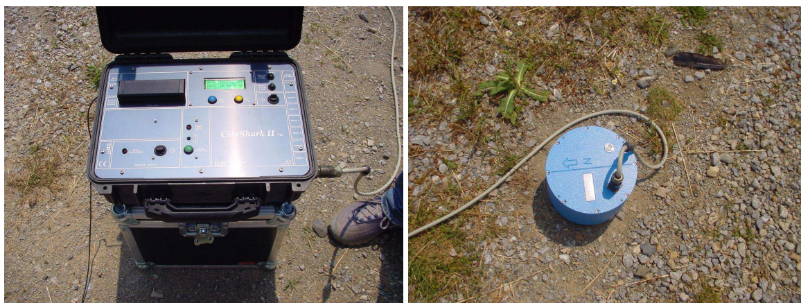
Figura 11: Equip de mesura de soroll sísmic: digitalitzador CityShark (esquerra) i sismòmetre Lennartz 5s. (dreta).
