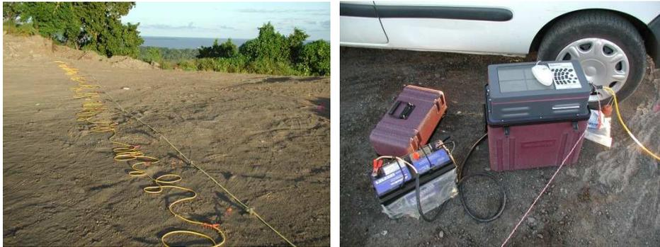
**Figure 39 - Dispositif MASW (à gauche : « flûte » de géophones, à droite : station d'acquisition)**
